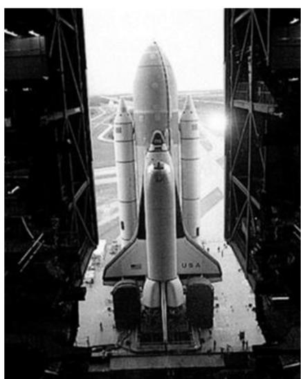
A fényképen látható ūrrepülőgép két szilárd hajtóanyagú gyorsító rakétával rendelkezik, amik kb. 40 km-es magasságban leválnak. A középső nagy tartály az ūrrepülő fő hajtóműveit látja el üzemanyaggal a felszállás során.
